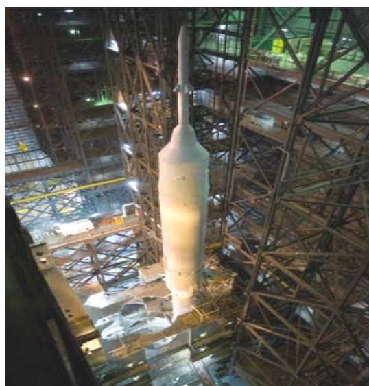
In alto. Una foto del gigantesco vettore Ares I-X, alto 93 metri. Dai tempi del Saturno V un veicolo così alto non era presente nel VAB!
